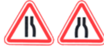
Знак "Сужение дороги":
